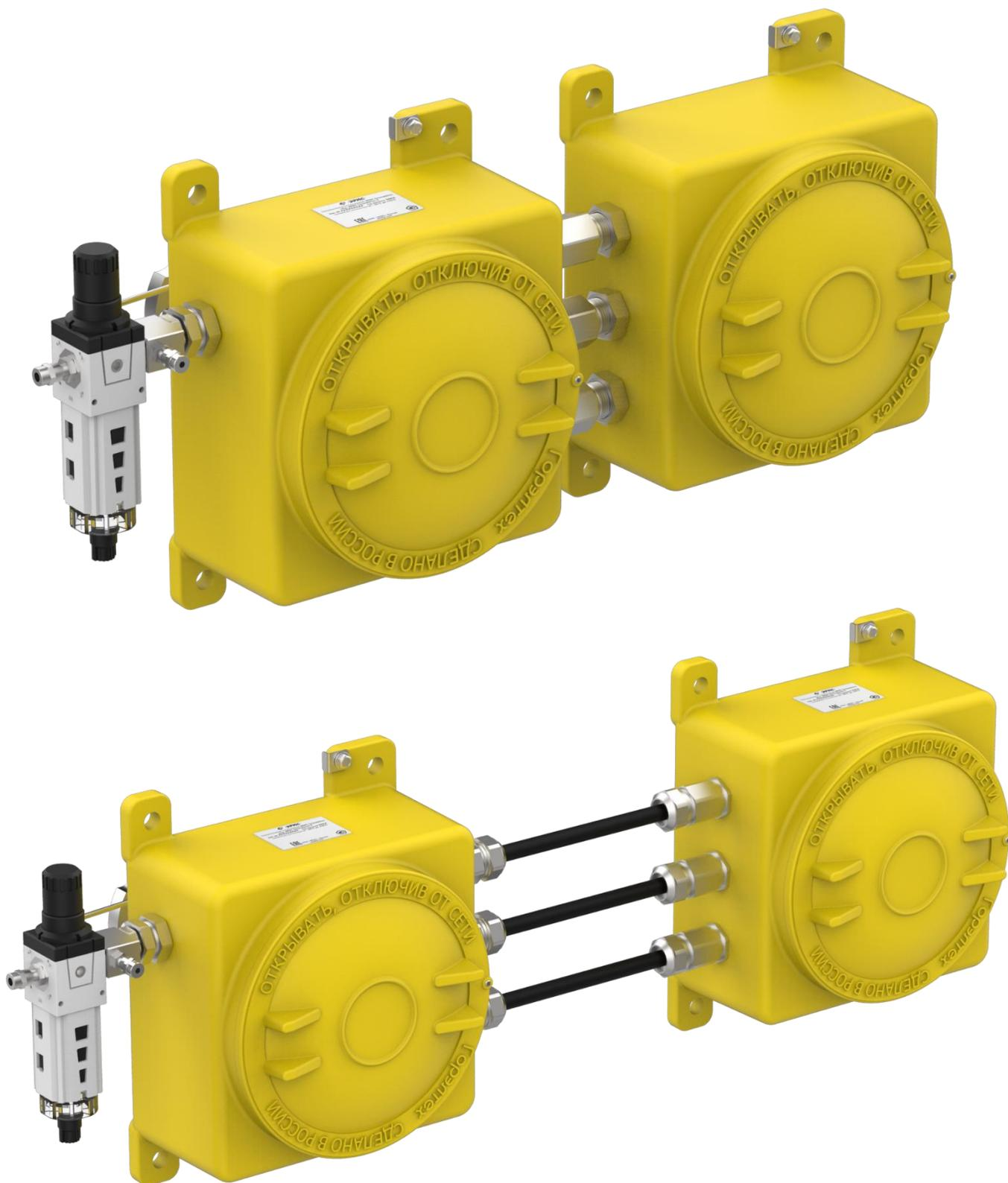
Рисунок 2 – Внешний вид измерительного блока газоанализаторов стационарных ЭРИС Оксидиркон 2, ЭРИС Оксидиркон 3, ЭРИС Оксидиркон 4, (жесткое соединение сенсорного и электронного блоков - выше, разделенного – ниже).
