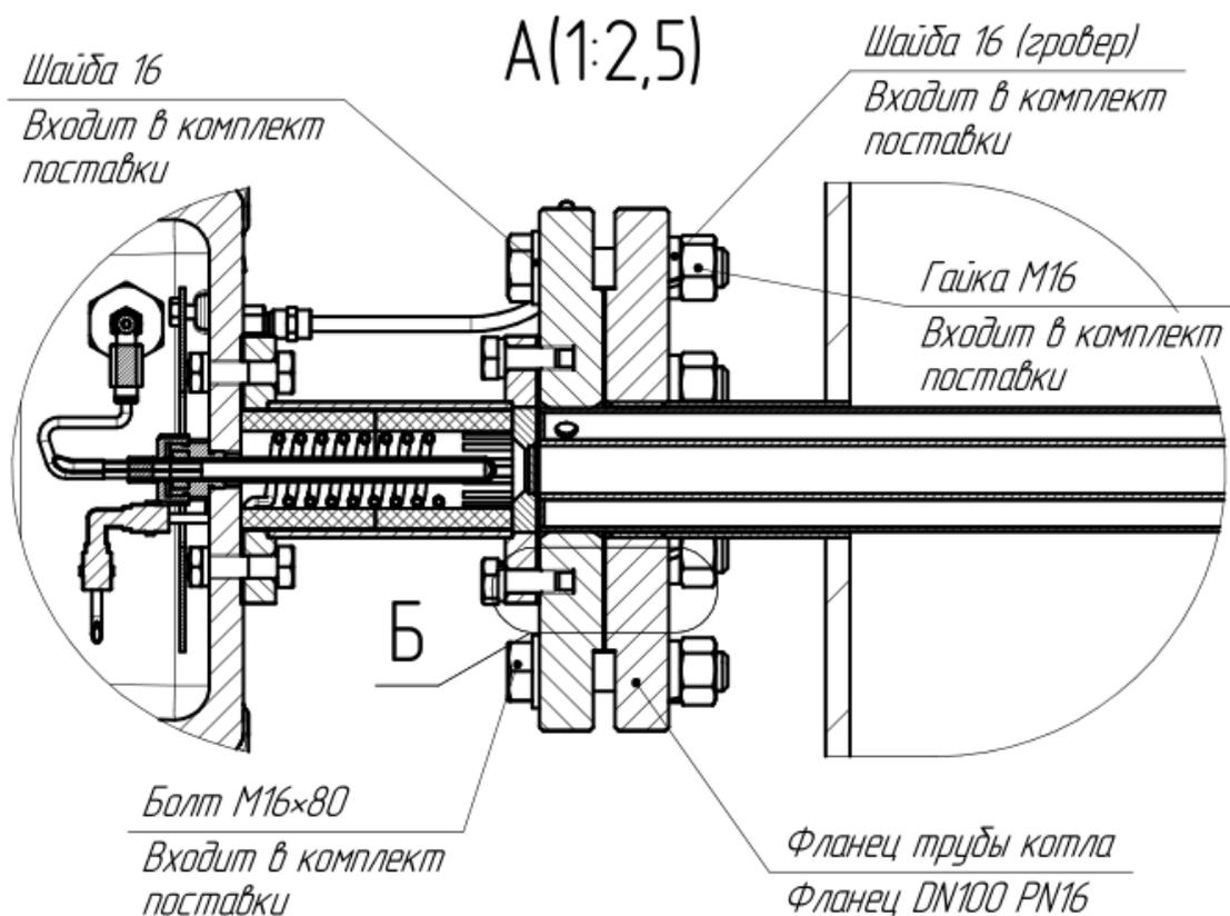
Рисунок 7 - Соединение фланцев
