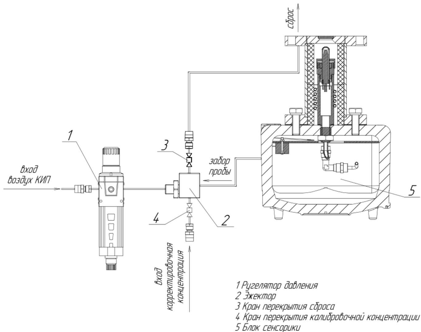
Рисунок В.1 – Пневматическая схема подключения газоанализатора модификаций ЭРИС Оксидиркон
