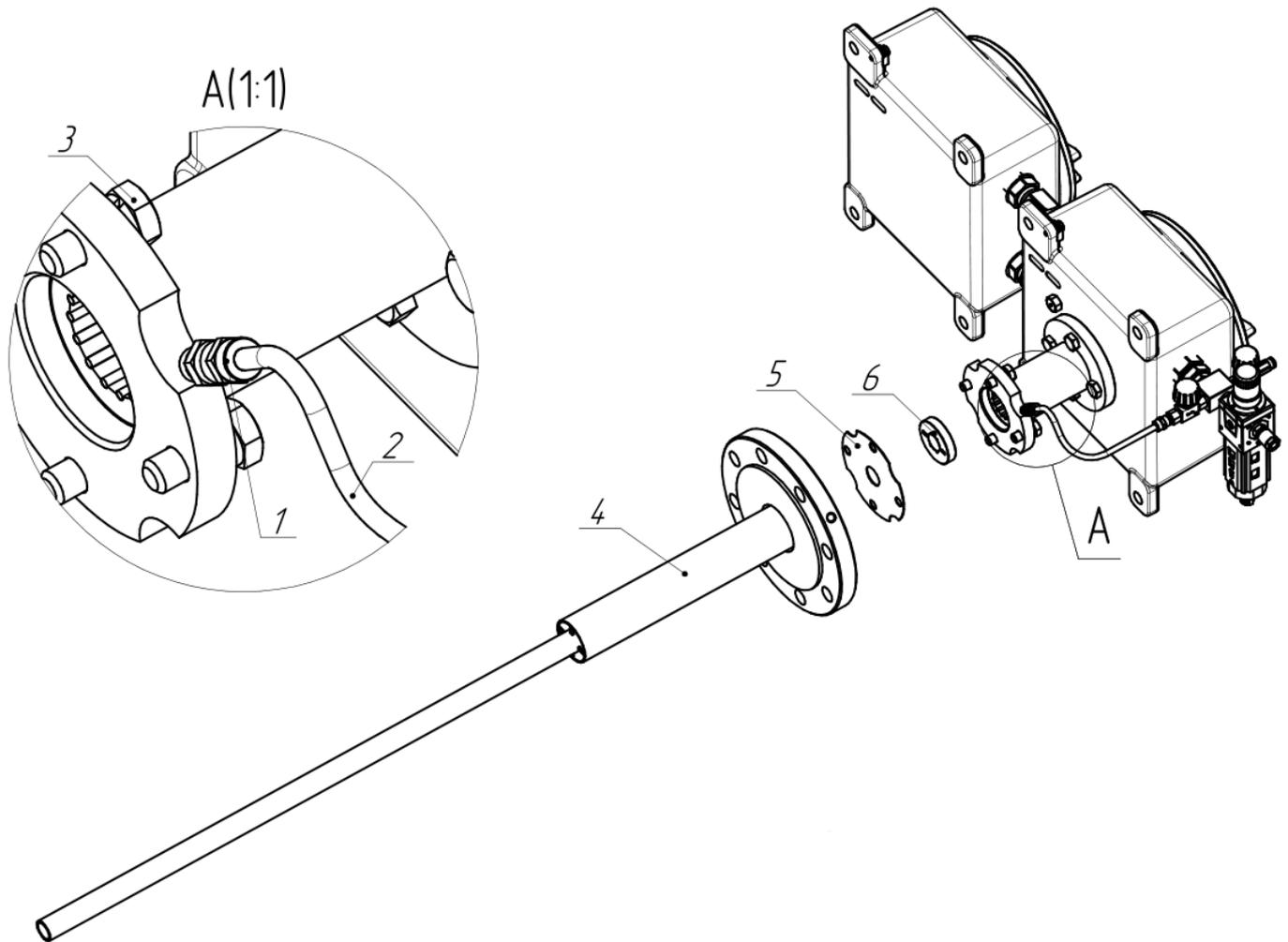
Рисунок 8 – Замена фильтра-огнепреградителя газоанализатора
