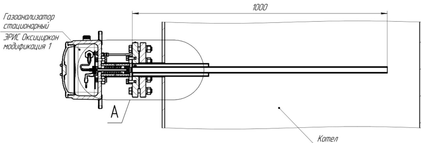
Рисунок 6 - Монтаж газоанализатора на котел (трубу)
