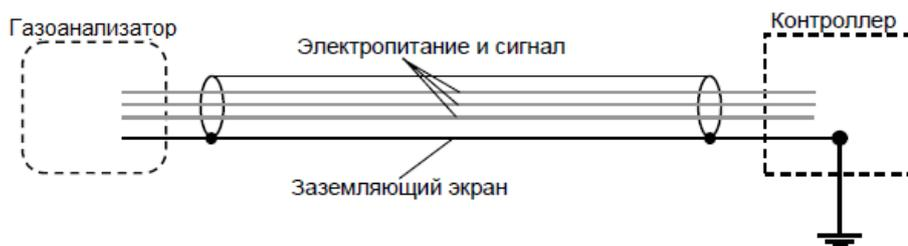
Рисунок 4 – Заземление экранированного кабеля
