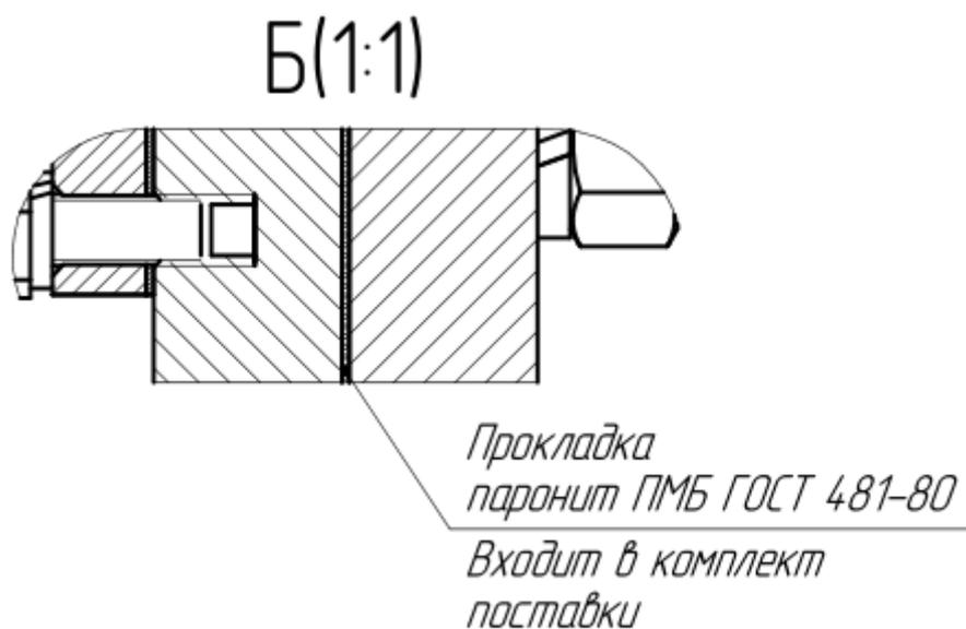
Рисунок 8 – Установка паронитовой прокладки
