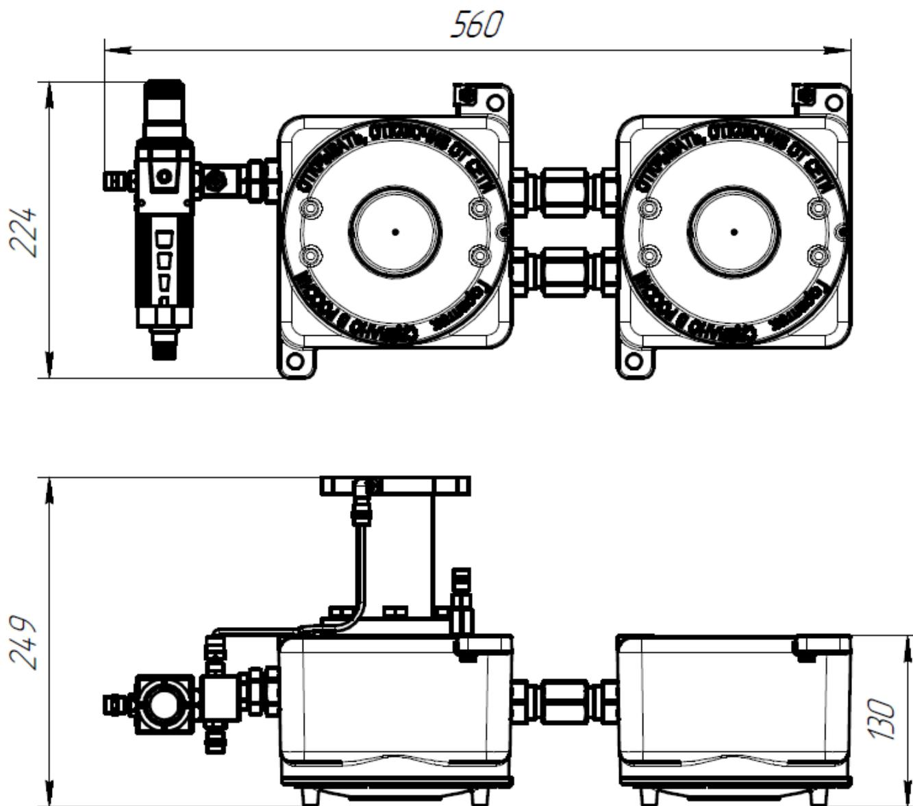
Рисунок А.1 – Габаритный чертеж модификации ЭРИС Оксициркон 1
