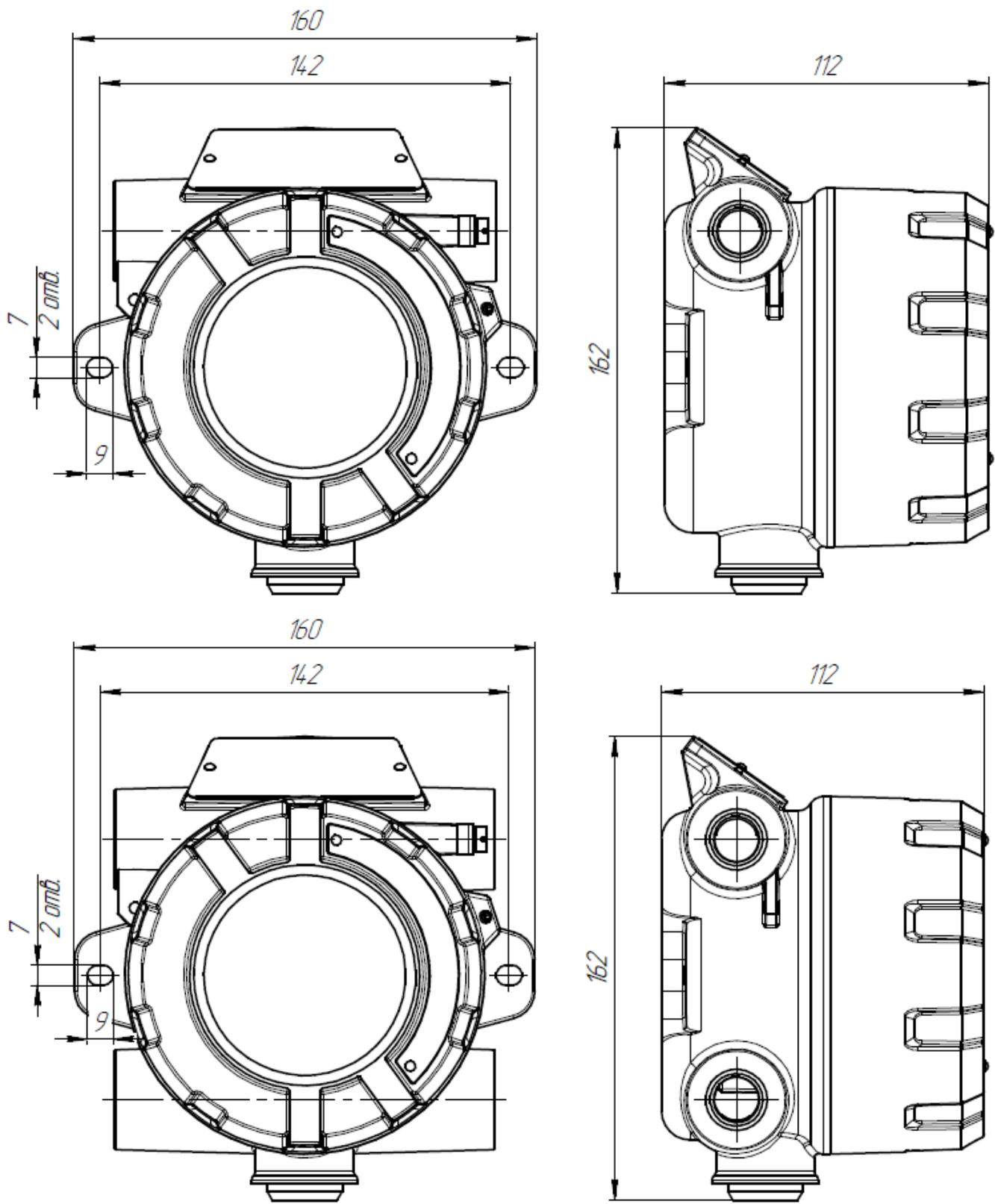
Рисунок А.3 – Габаритные чертежи терминальных блоков с указанием монтажных размеров
