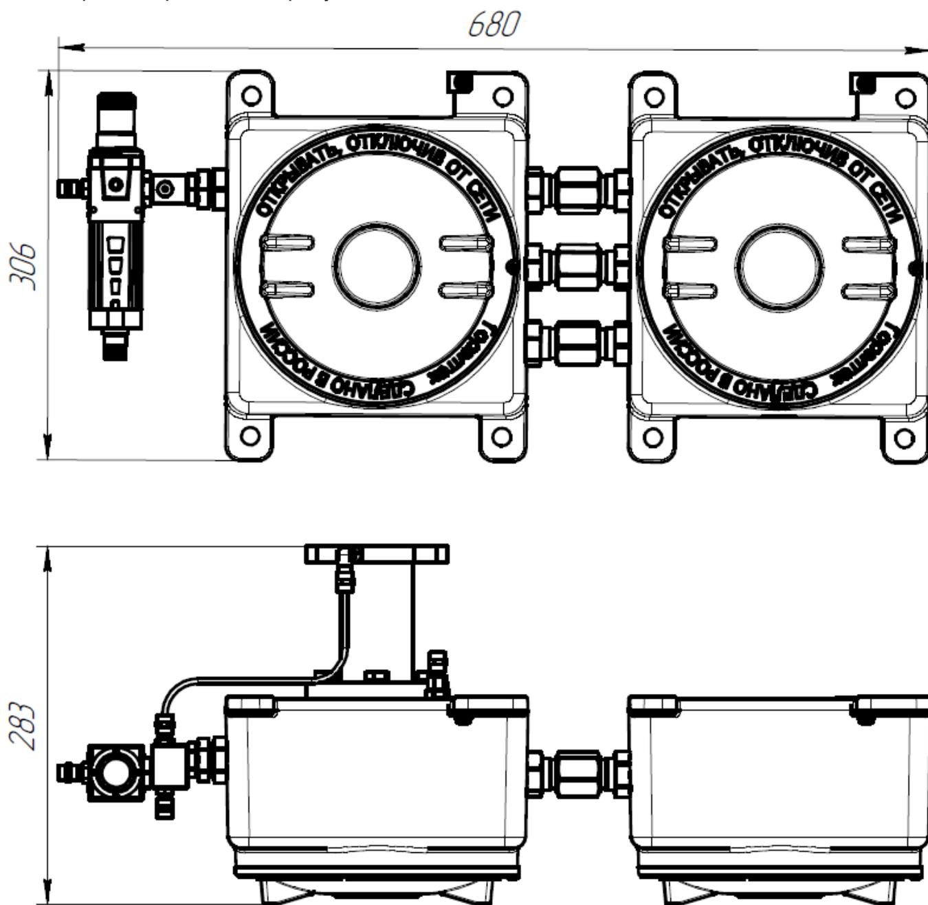
Рисунок А.2 – Габаритный чертеж модификации ЭРИС Оксициркон 2, ЭРИС Оксициркон 3, ЭРИС Оксициркон 4
