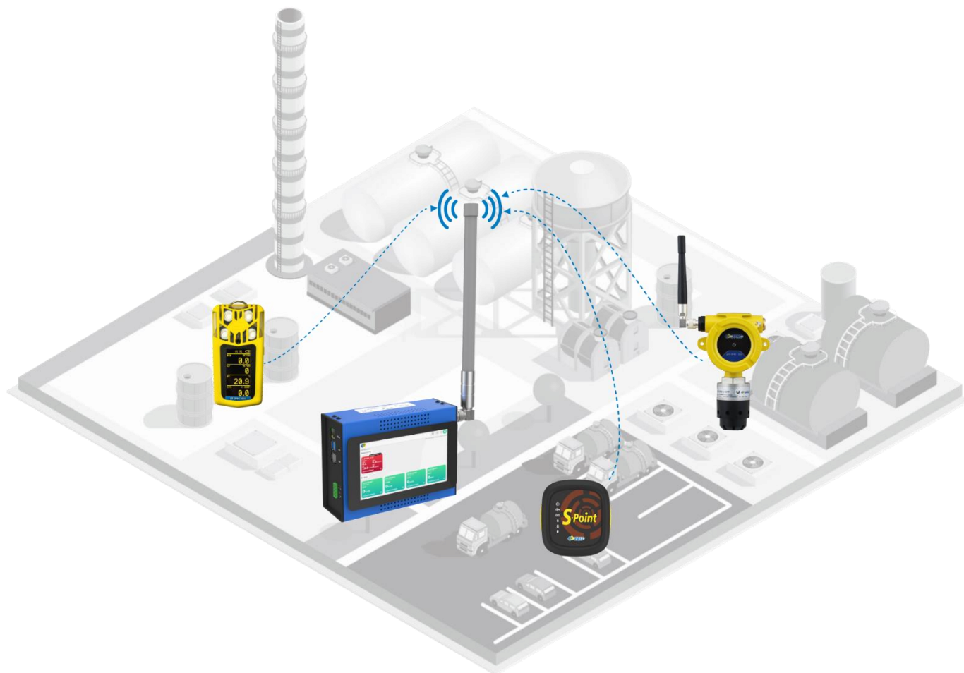
Рисунок 1 – Схема взаимодействия LogaBOX и устройств сопряжения
