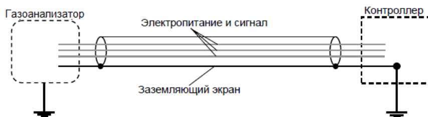
Рисунок 21 – Заземление экранированного кабеля
