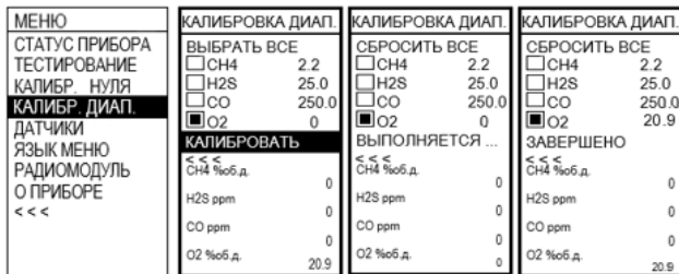
Рисунок 6 – Корректировка диапазона сенсора кислорода
