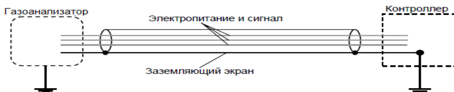
Рисунок 21 – Заземление экранированного кабеля
