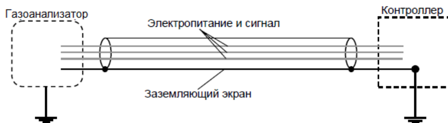
Рисунок 21 – Заземление экранированного кабеля
