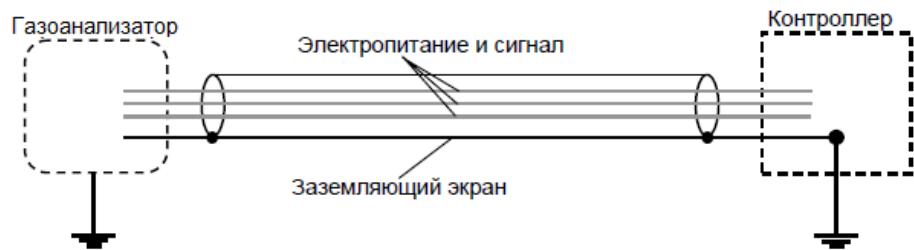
Рисунок 21 – Заземление экранированного кабеля
