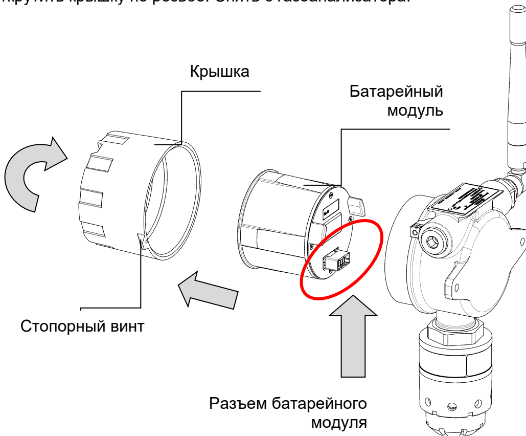
Рисунок 25 - Схема разбора газоанализатора для активации (вид сзади)
