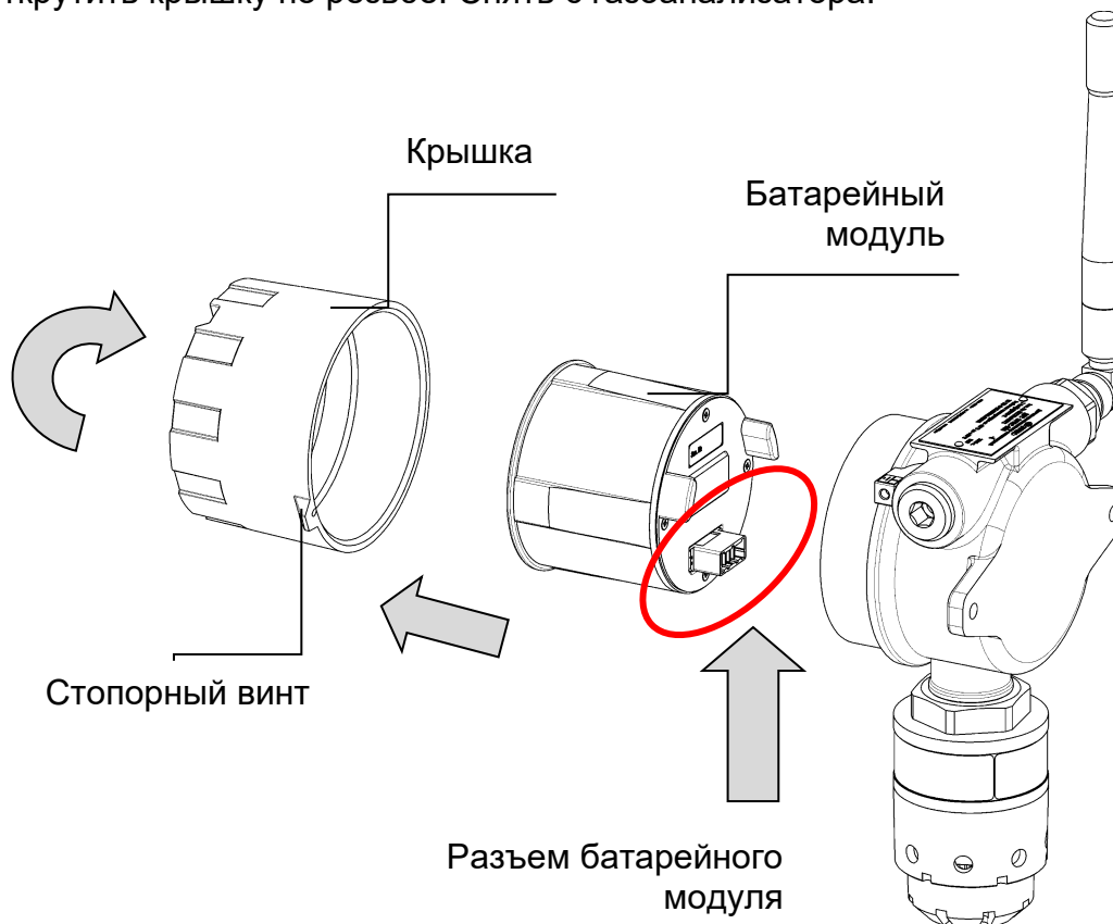
Рисунок 23 - Схема разбора газоанализатора для активации (вид сзади)
