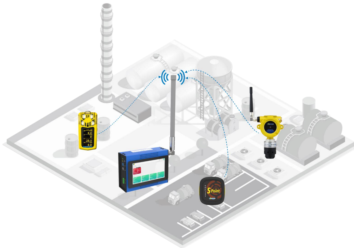
Рисунок 1 – Схема взаимодействия LoraBOX и устройств сопряжения
