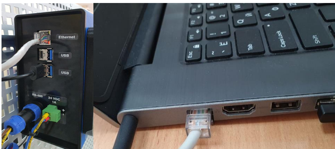
Рисунок В.2 – Подключение сетевого кабеля
